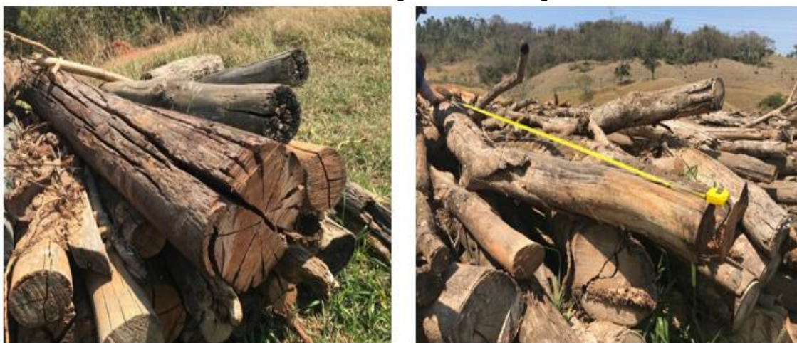
Figura 7.6 - Evidências de rachaduras radiais e tangenciais, diâmetros diversos e elevado encurvamento da biomassa gerada na Barragem Pedreira
