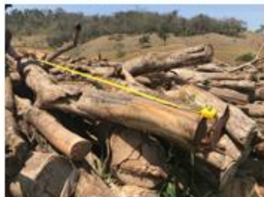
Foto 6 – Em detalhe o elevado grau de encurvamento encontrado em tora amostrada na pilha (setembro/2019).
