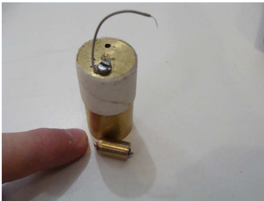
Figura 3.8 – Parte interna do sensor de nível pendular com o pêndulo interno removido em destaque.
