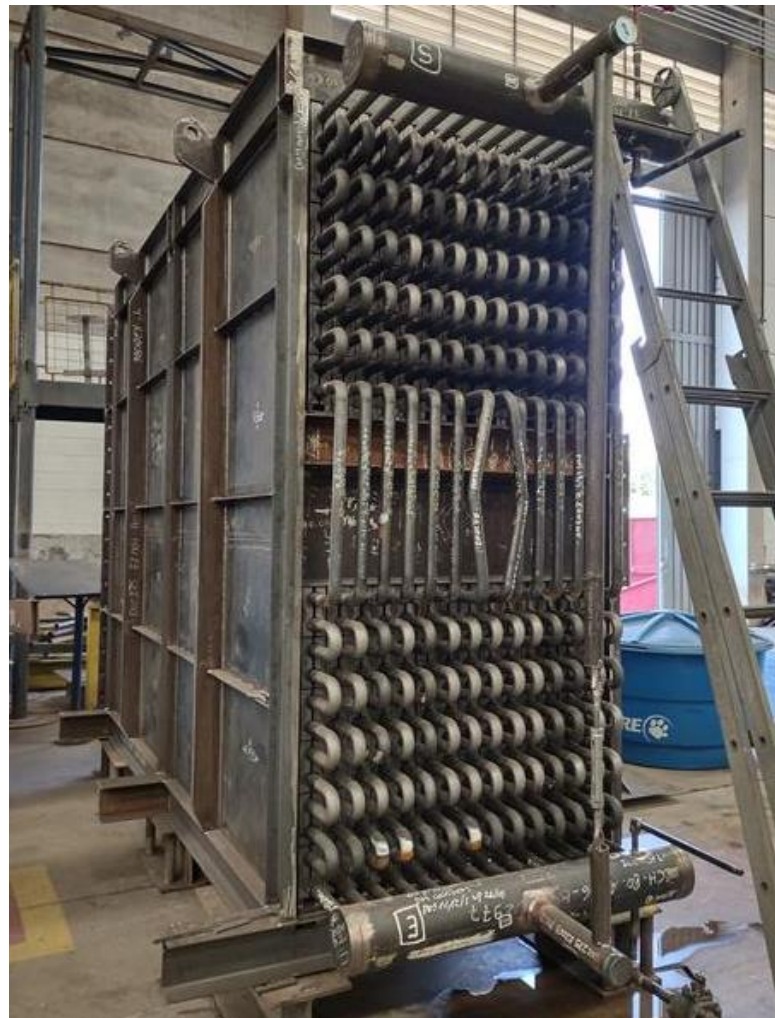
Figura 13 – Economizador de uma caldeira MD-FV-50 (DANPOWER, 2021).
