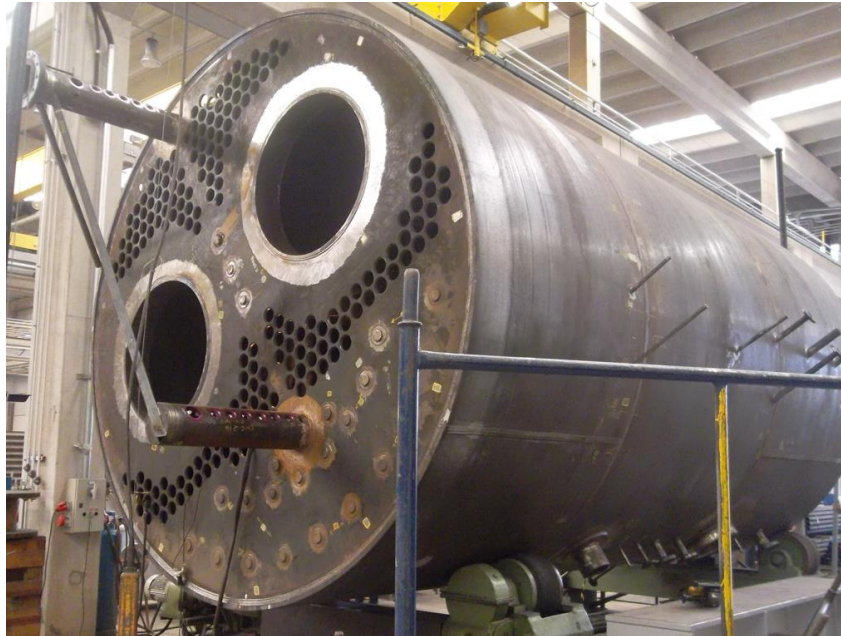
Figura 5 – Caldeira Flamotubular TPS-30000 fabricação (DANPOWER, 2021).
