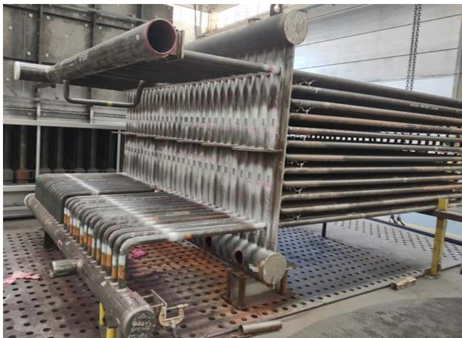
Figura 10 – Superaquecedor de uma caldeira MD-FV-50 (DANPOWER, 2021).
