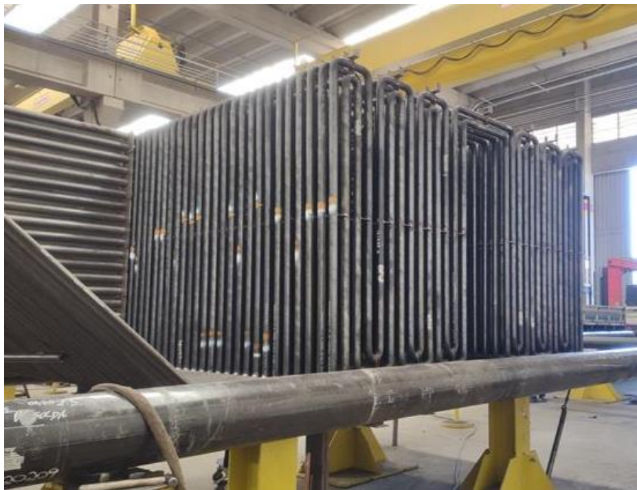
Figura 11 – Evaporador caldeira MD-FV-50 (DANPOWER, 2021).
