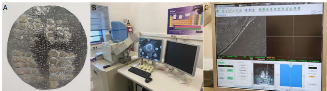
Figura 6. (A) Slices fixados em stub metálico e recobertos com camada ultrafina de ouro-paládio. (B) Microscópio eletrônico de varredura JSM-6610LV. (C) Programa SEM Control User Interface v.3.06.
