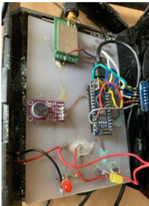
Figura 27 – Corrosão do protótipo 1 após operação
