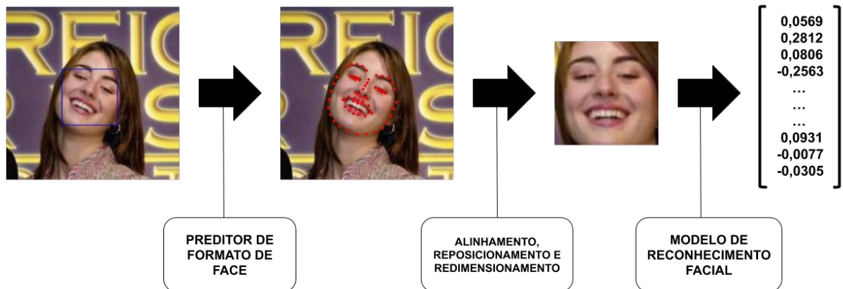
Figura 13 – Esquema de processamento da imagem em um descritor de face
