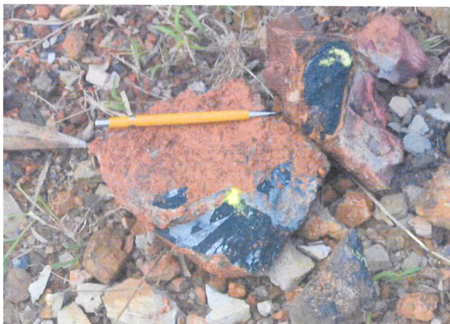
Figura 2 – Teste de campo com uso de molibdato de amônio que, em contato com fosfato, reage com precipitado amarelo de amostra de nova ocorrência, na base da Formação Guaicurus.
