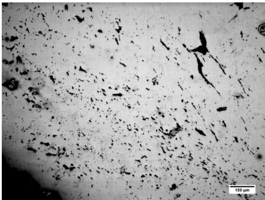
Figura 20: Microscopia óptica, sem ataque químico, da amostra 182, com aumento de 100x.
