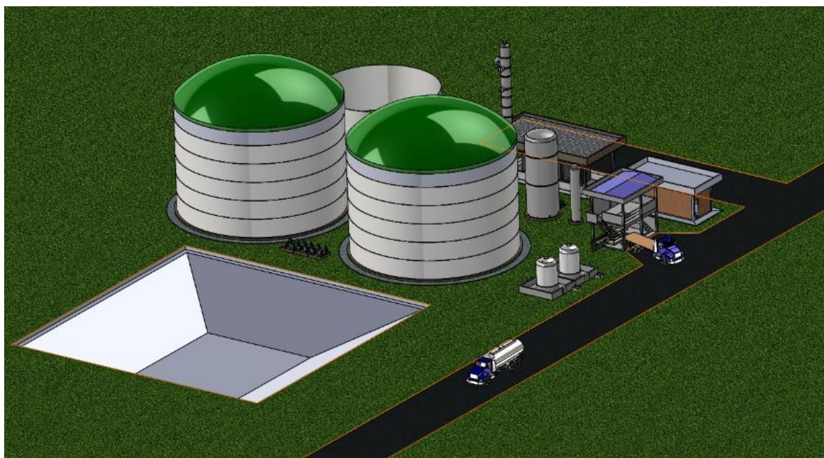
Figura 5.8 – Layout em 3D para a Planta de Biodigestão Anaeróbica e Dessulfurização
