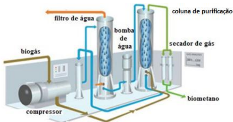
Figura 3.13 – Absorção física de dióxido de carbono pelo processo de lavagem
