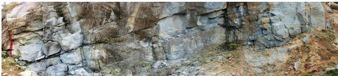
Figura 4.9: Scanline MB-01, perfil S-N subvertical, largura entre as marcações em tinta de 30m.
