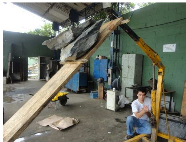
Figura 3.4: Estrutura montada para tilt test e um dos ensaios em execução
