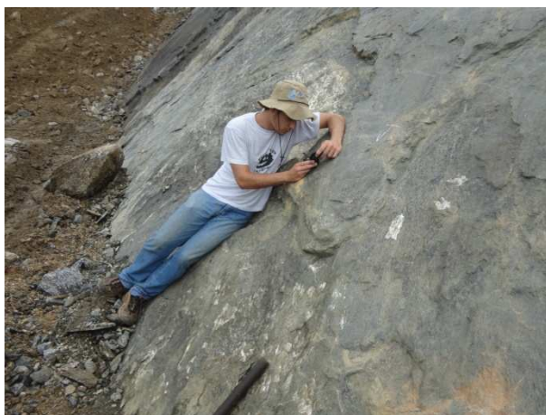
Figura 3.3: Tomada de orientação do bloco escolhido ainda in situ .
