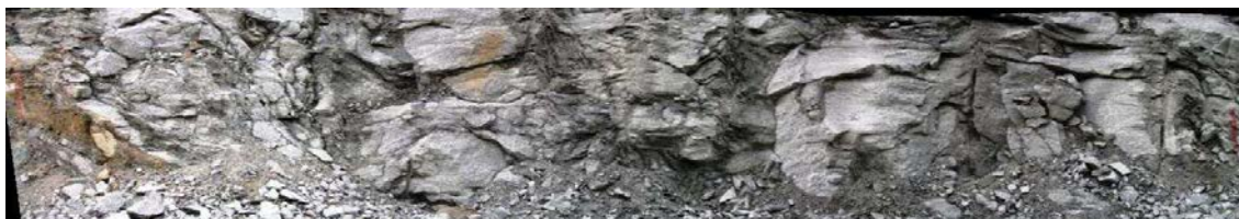
Figura 4.11: Scanline MB-03, perfil NNE-SSW subvertical, largura entre as marcações em tinta de 30m.
