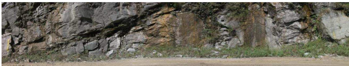
Figura 4.10: Scanline MB-02, perfil ESE-WNW subvertical, largura entre as marcações em tinta de 30m.
