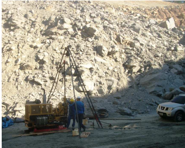
Figura 3.5 – Furo de sondagem rotativa com recuperação de testemunho em execução.
