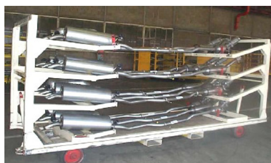
Figura 21: Base-rolante para transporte de escapamentos (fluxo síncrono) (Fonte: documento interno da empresa)
