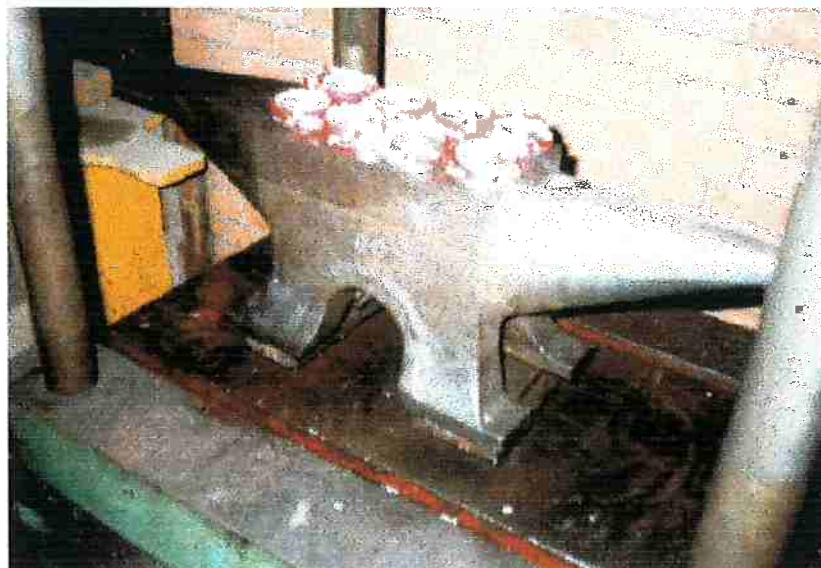
Figura 4.3: Compactação das latas em prensa hidráulica
