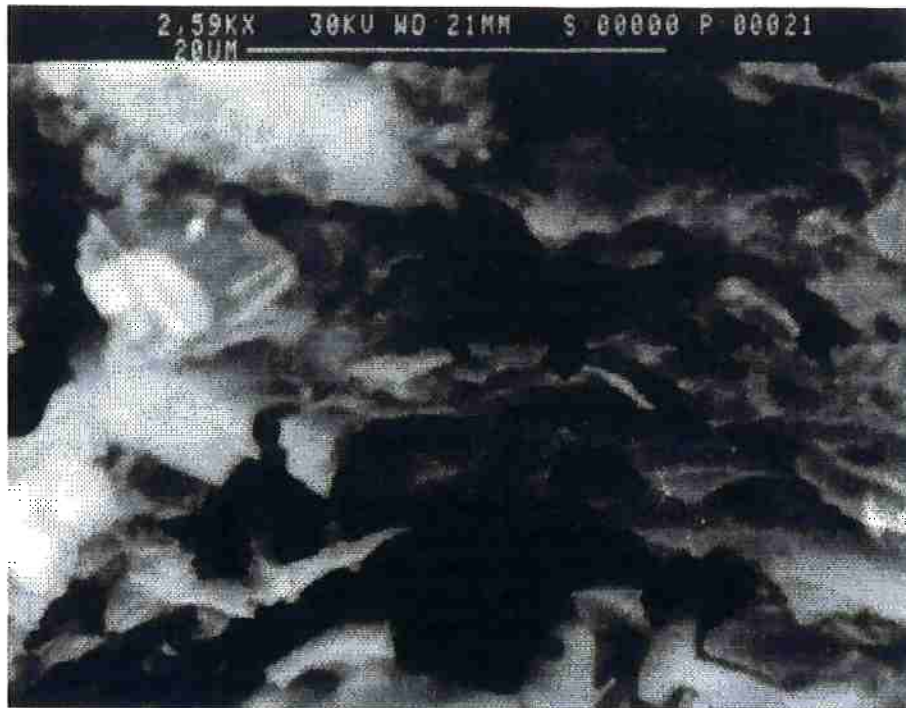
Figura 2.10: Imagem de elétrons secundários. Fragmentos de óxido em drossa tratada com fluxo.
