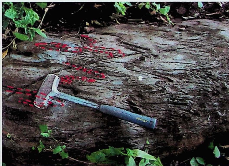
Foto 7: Ponto 21 – Metacalcário estratificado cinza escuro. Transposição da estratificação dada por zonas de charneira rompidas.
