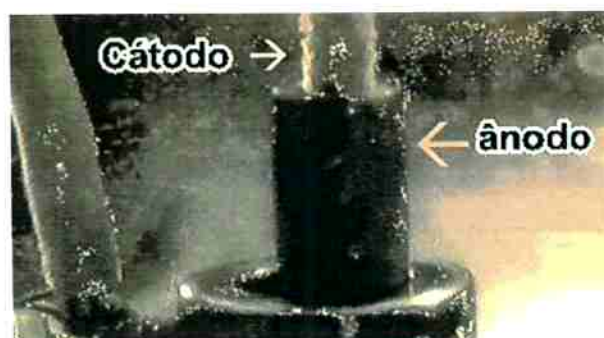
Figura 8: Liberação de gás oxigênio na superfície do anodo e gás hidrogênio na superfície do catodo. Em detalhes, observa-se um sistema onde se vê um tubo (anodo) com inserção de um catodo dentro deste. Adaptado de (Lee, 2000).
