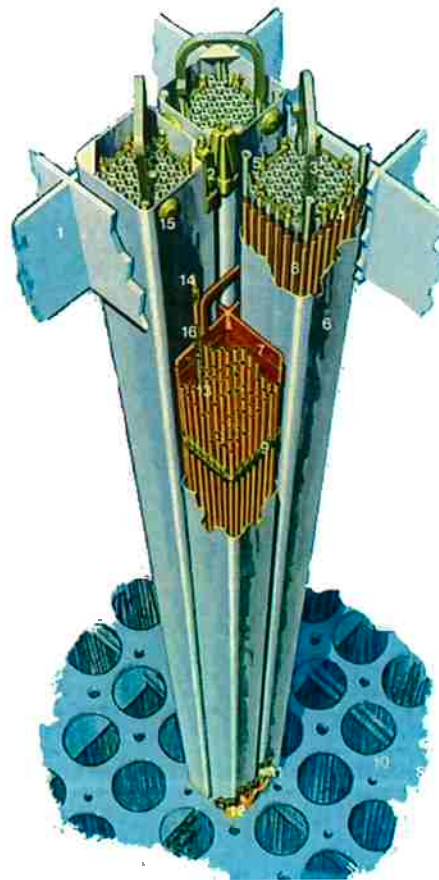
Figura 15: Desenho de elemento combustível de um reator do tipo BWR.
