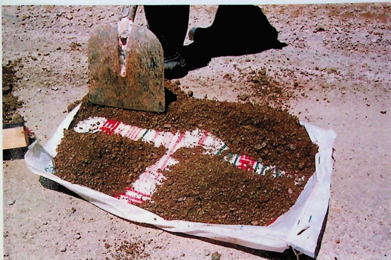
Foto 2.1: Quarteamento em pilha cônica realizada em campo.
