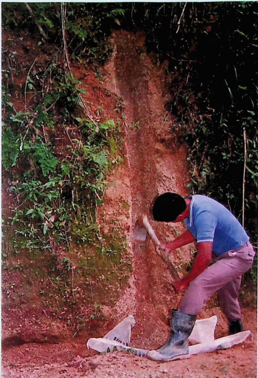
Foto 4.5: Amostragem de canal P9-C2 na Área Vargem Grande.
