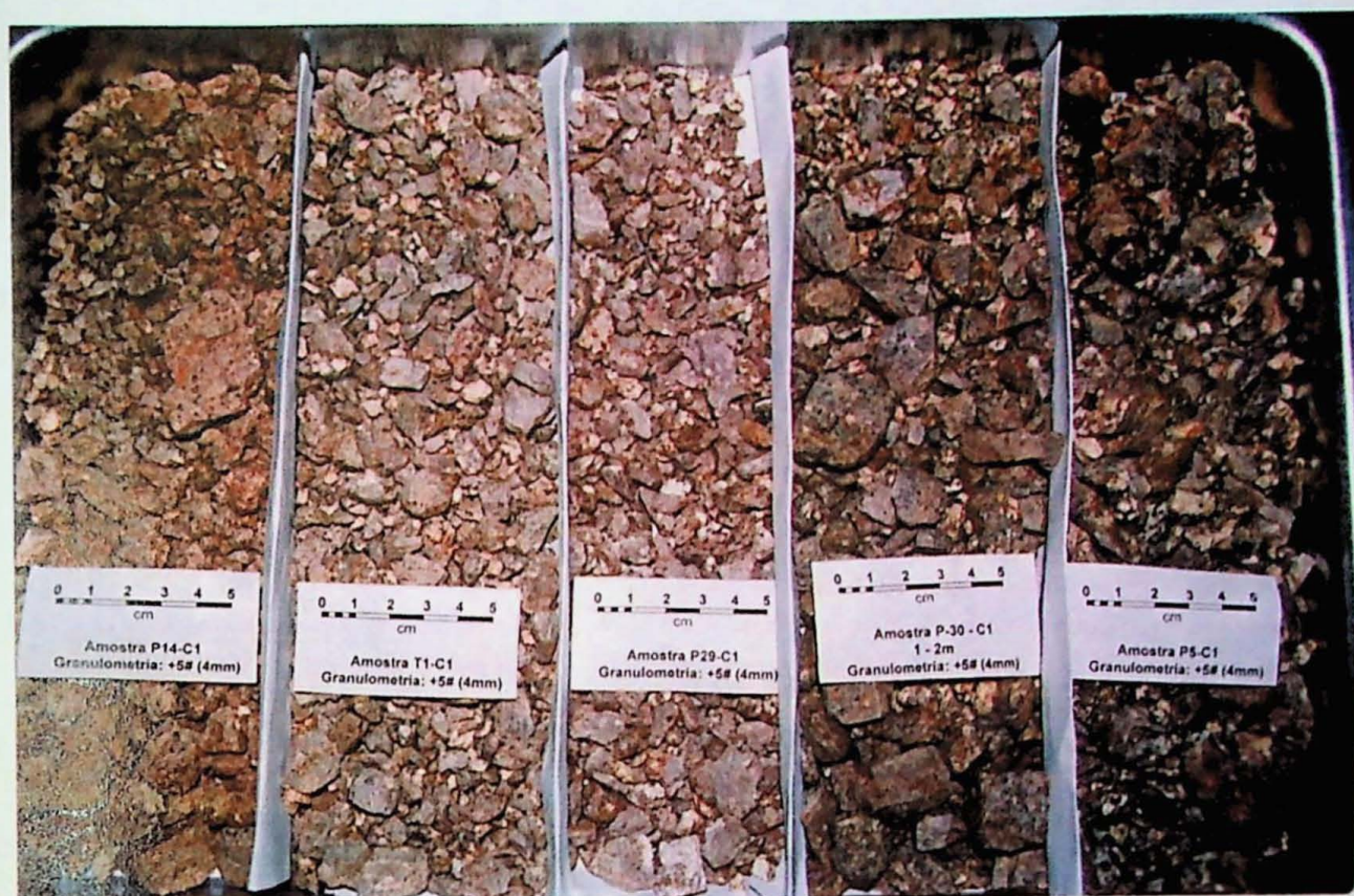
Foto 4.7: Aspecto geral da fração +5# após peneiramento à úmido das amostras do Vargeado. Grau de alteração do material crescente da direita para a esquerda.
