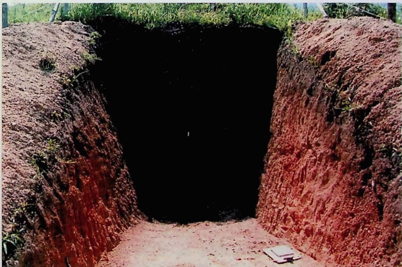
Foto 4.2: Trincheira T-01 da área Vargeado com amostragem de canal em sua parede.
