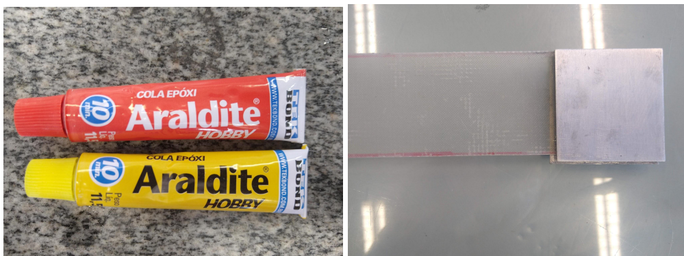
Figura 6 – a) Cola Epóxi Araldite usada para colagem dos tabletes de alumínio. b) Tabletes de alumínio colados na extremidade do laminado.
