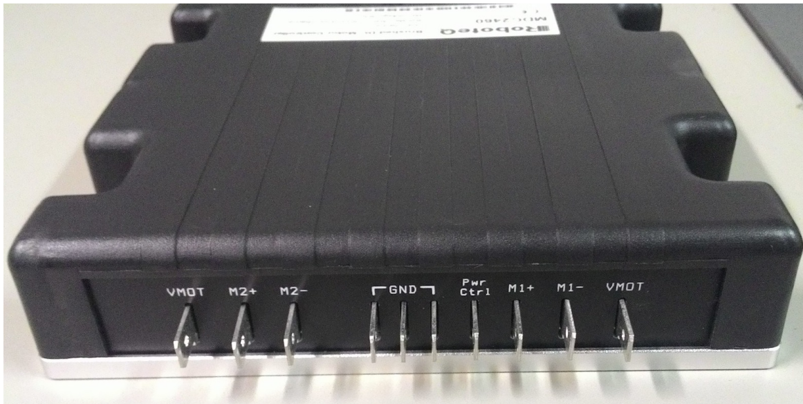
Figura 3.5: Controlador MDC2460: terminais Faston de 0,25 polegadas.
