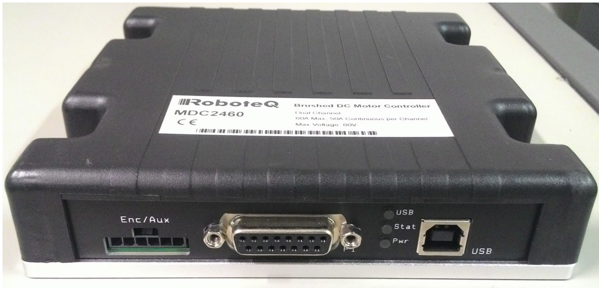
Figura 3.4: Controlador MDC2460: entrada para encoders , conectores DB15 e USB.
