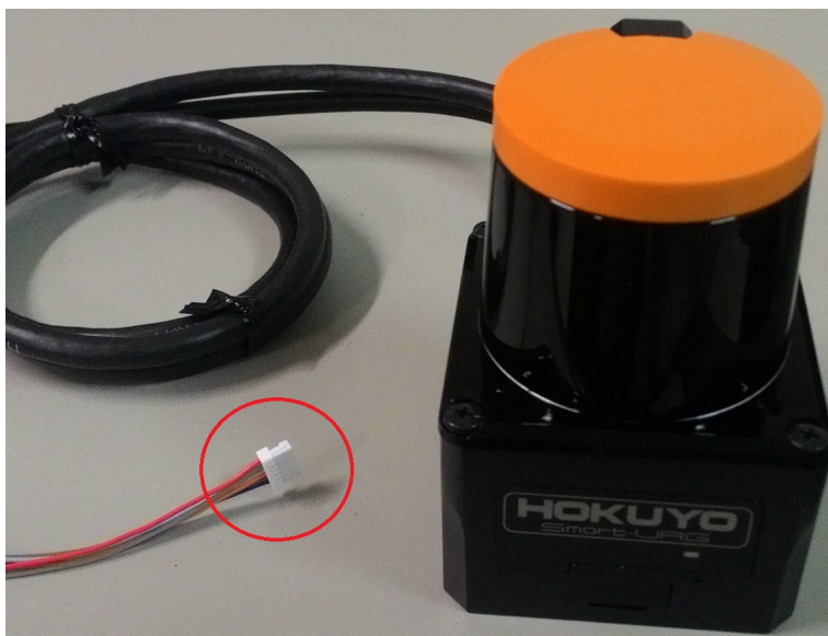
Figura 3.19: O círculo vermelho indica o conector JST do sensor UST-10LX.
