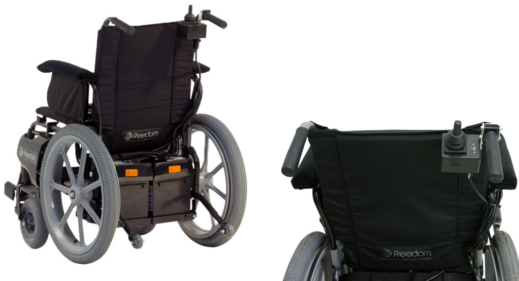
Figura 1.7: A cadeira de rodas motorizada Freedom SE apresenta um joystick para o acompanhante. 7
