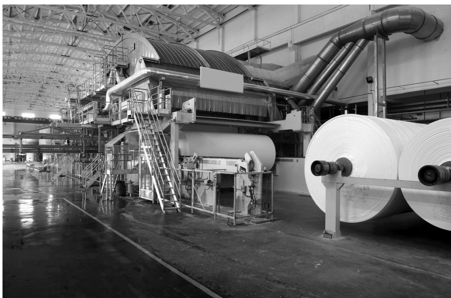
Figura 3.2 - Máquina contínua de produção de papel Fonte: Institucional
