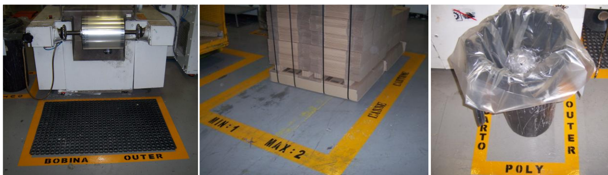
Figura 4.3 - Posicionamento dos materiais nas linhas
