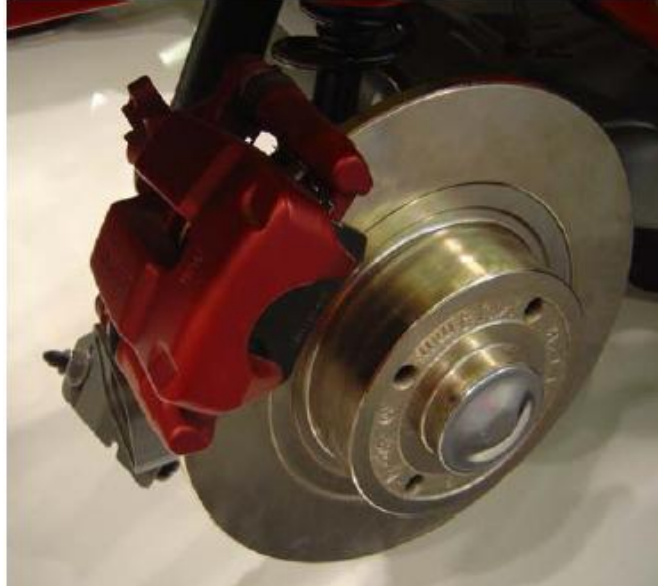
Figura 4: Freio a disco: disco, pastilha e caliper . (Fonte: Talati e Jalalifar (2009)).
