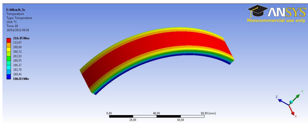
Figura 41: Gradiente de temperatura ao final do processo de frenagem para 60 km/h e intervalos de 5s.
