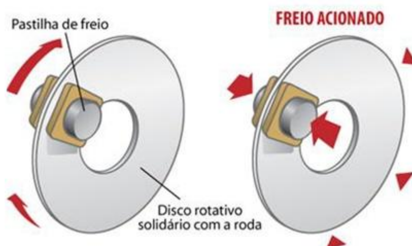
Figura 5: Esquema de freio a disco (Fonte: Silveira e Carvalho (2011) apud Porpígio (2012)).
