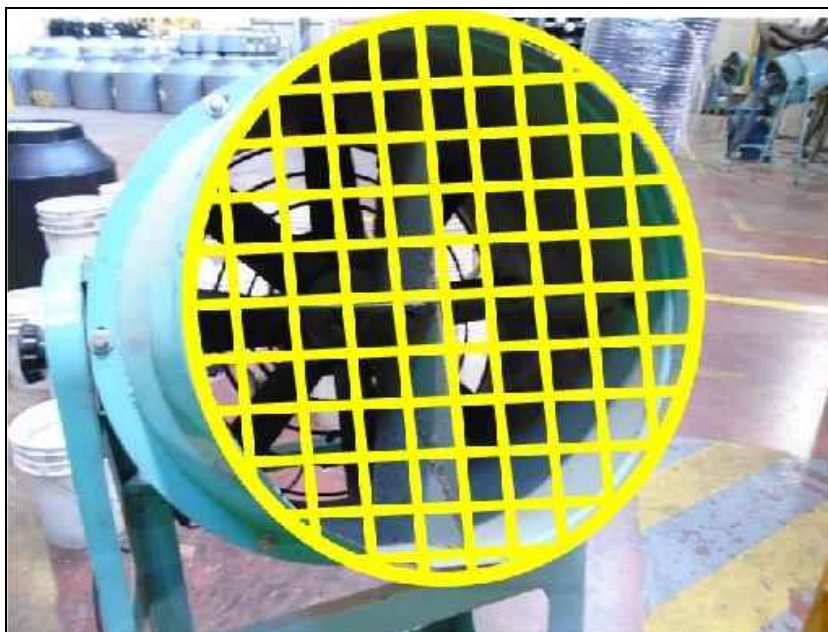
Figura 28 – Solução para redução de risco no ventilador.
