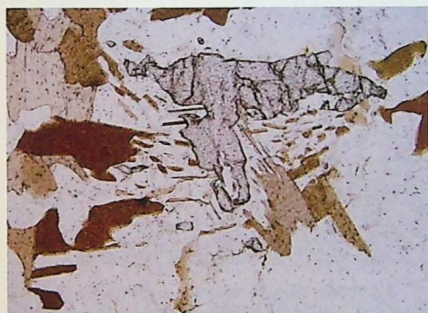
Foto 20. Intercrescimento esquelético de biotita + quartzo ± feldspato substituindo granada. Nicois descruzados. Lado maior = 1,3mm.
