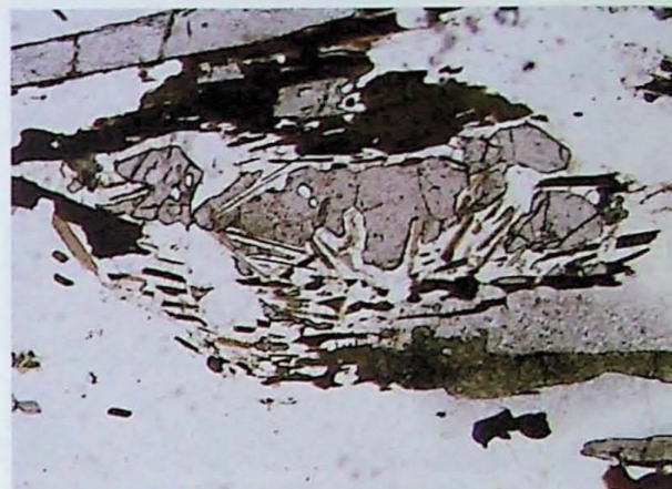
Foto 19. Intercrescimento esquelético de biotita + quartzo ± feldspato substituindo granada. Nicois descruzados. Lado maior da foto = 2,6mm.
