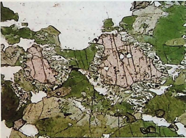
Foto 26. Granada substituída parcialmente por hornblenda + plagioclásio. Nicois descruzados. Lado maior da foto = 3,2mm.
