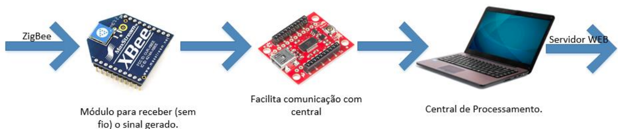
Figura 33: Integração dos componentes na central doméstica – Todas as figuras utilizadas nessa composição, já foram referenciadas anteriormente.
