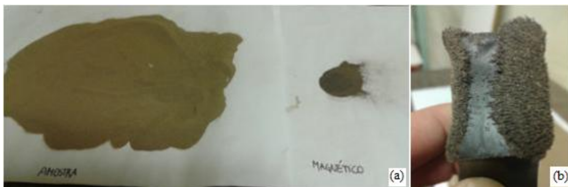
Figura 8 - Separação da porção magnética e não magnética da amostra. (a) Amostra sendo separada.
