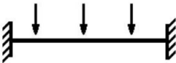
Figura 2-3 Representação do corpo da célula de carga na configuração viga dupla engastada [6].
