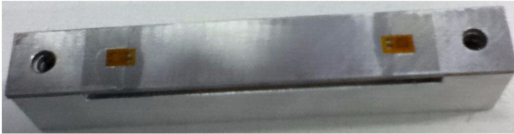
Figura 2-11 Extensômetros fixados ao corpo de prova da célula de carga [6].
