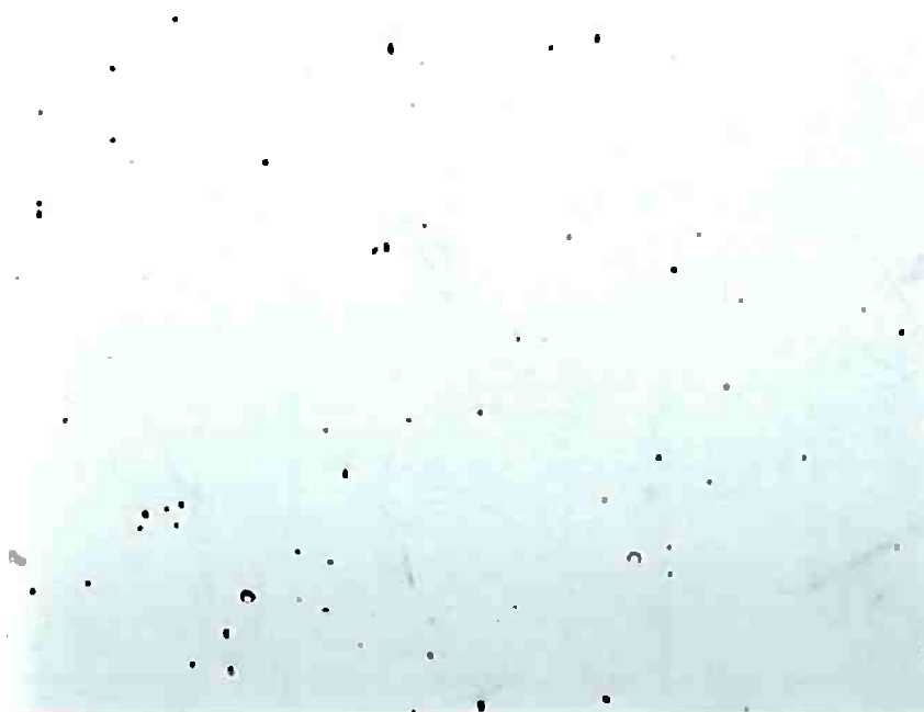
Foto 1. - Inclusões presentes no parafuso sem hidrogênio ( 75 X )
