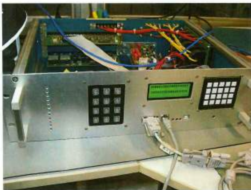
Figura 15: Painel Frontal do hardware adaptado.
