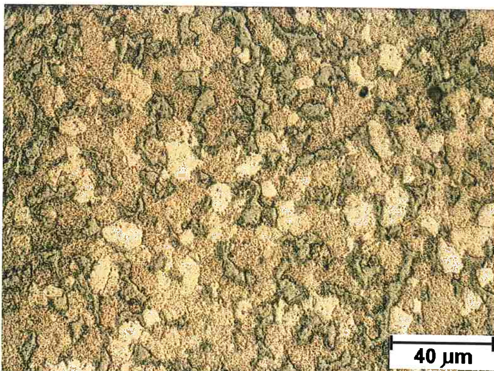
Figura 4.5: Liga Sn (60) –Pb (40) . Fase alfa-chumbo com coloração mais escura, fase beta-estanho com variadas tonalidades. Ataque: Ácido Clorídrico, Ácido Nítrico, Etanol. Aumento: 500x (MO).
