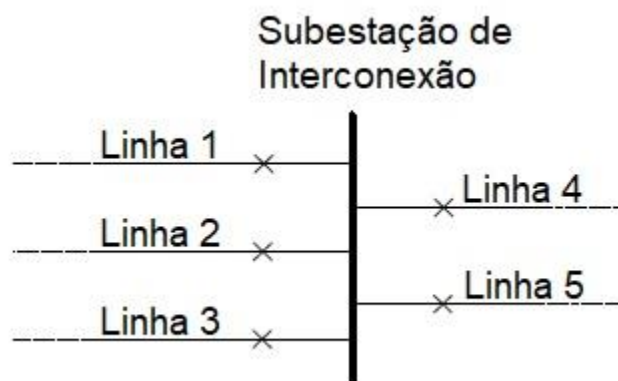
Figura 2: Exemplo de subestação de interconexão.
