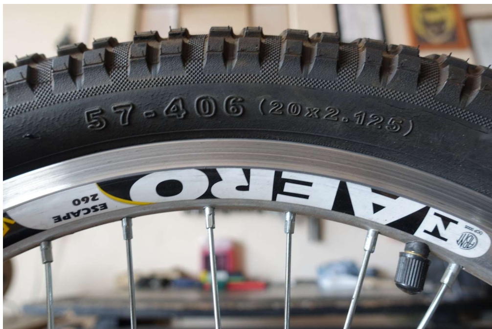
Figura 25 - Dimensões do pneu da bicicleta utilizada na simulação
