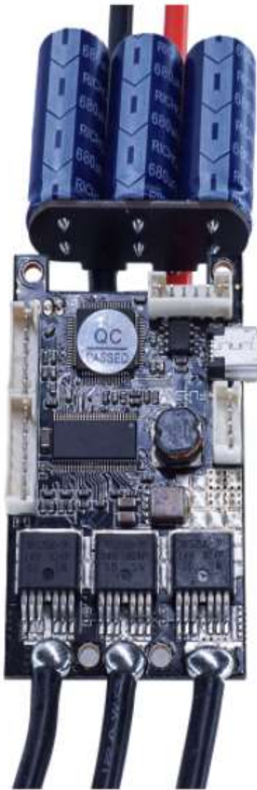
Figura 29 - Controlador Externo de velocidade(ESC) para 36V
