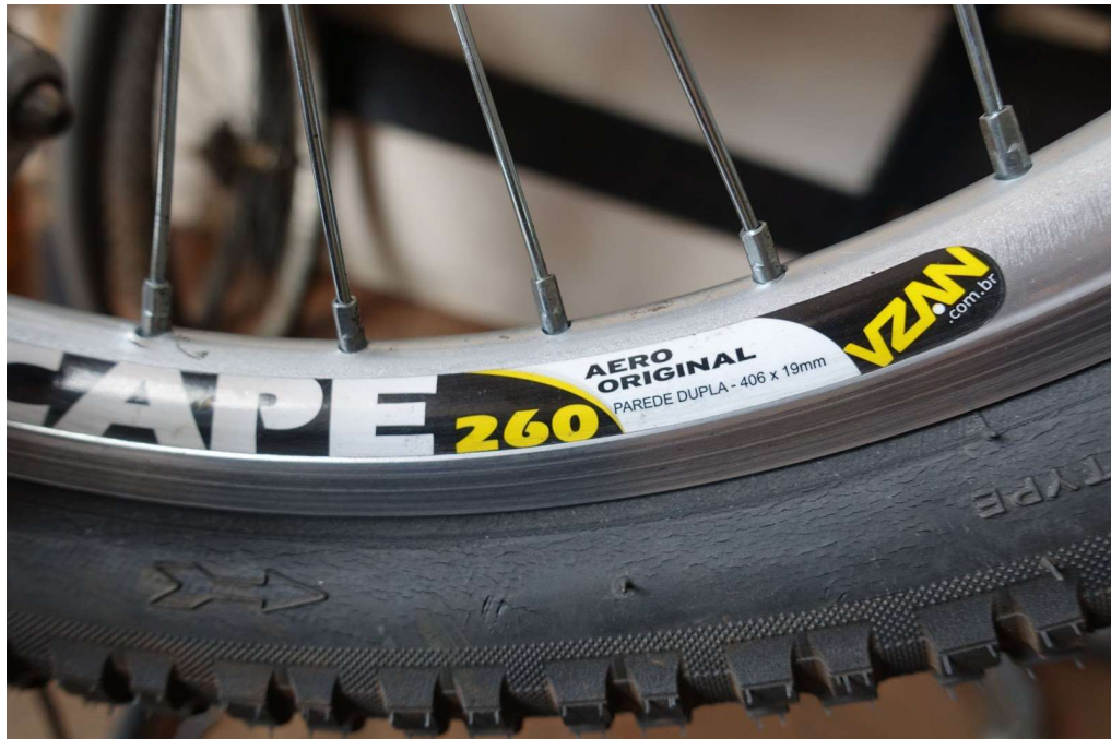
Figura 24 - Dimensões do aro da bicicleta utilizada na simulação
