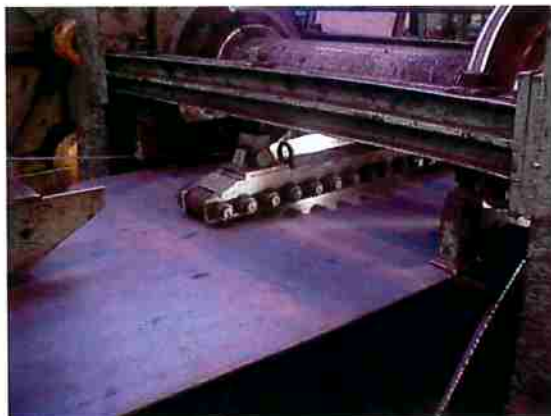
Figura 13 – Etapa de corte de aparas das bobinas [16]
