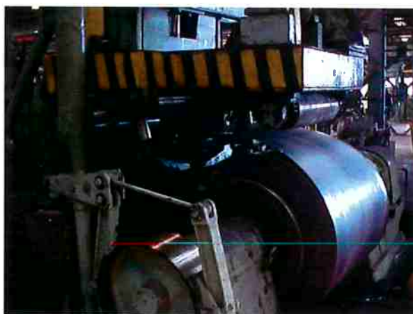
Figura 12 – Etapa de desbobinamento [16]
