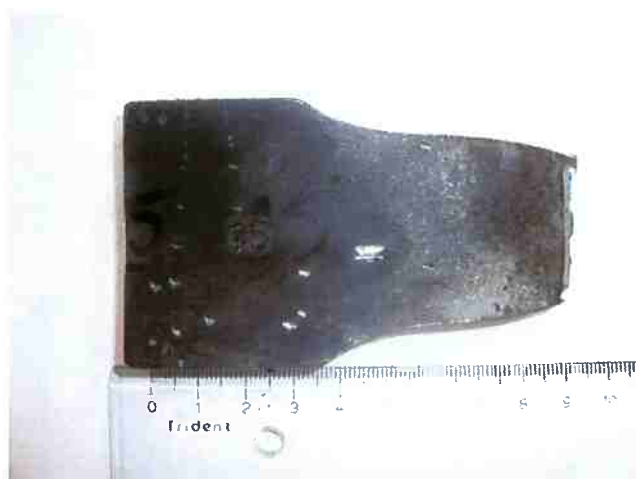
Figura 19 - Amostra após ensaio de tração.
