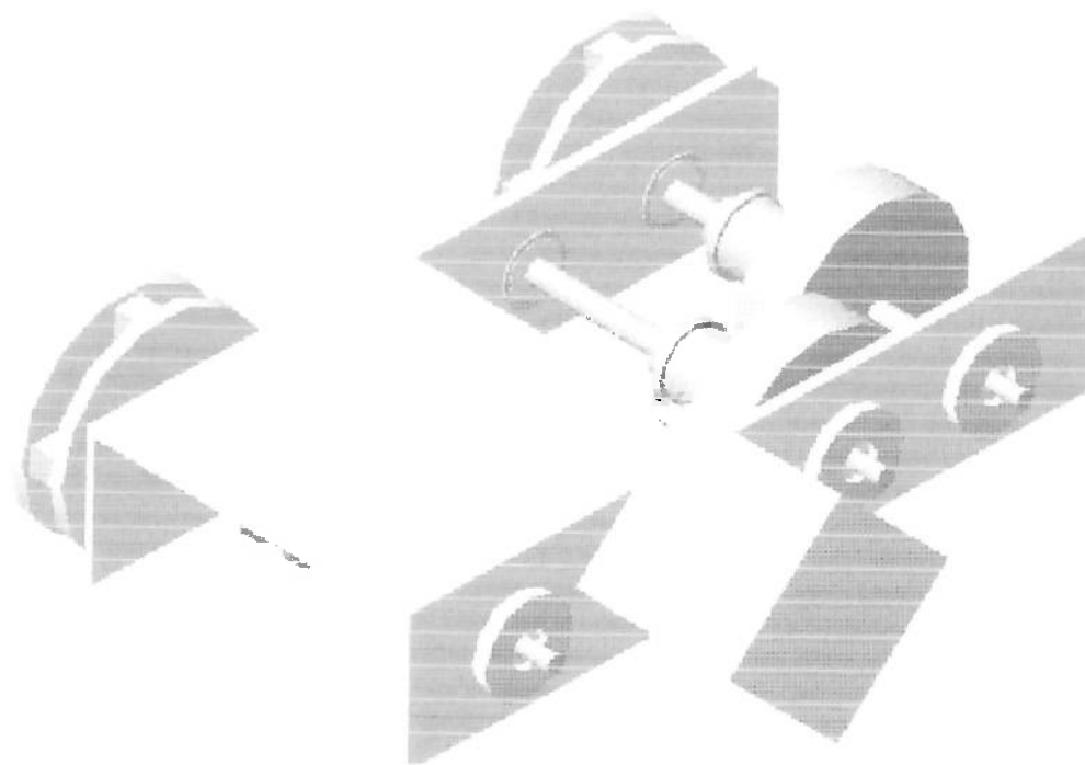
Figura 14 Desenho de Conjunto em Perspectiva de Metade do Sistema de Locomoção
