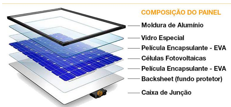
Figura 35 - Componentes do painel fotovoltaico
