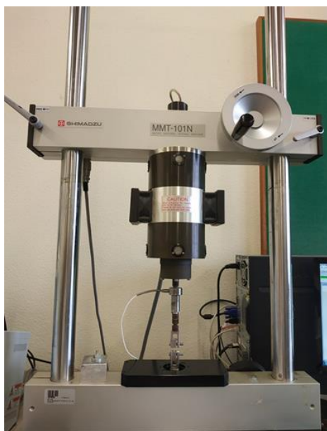
Figura 11 - Equipamento MMT-101N, da Shimadzu, para ensaios mecânicos com micro materiais.
