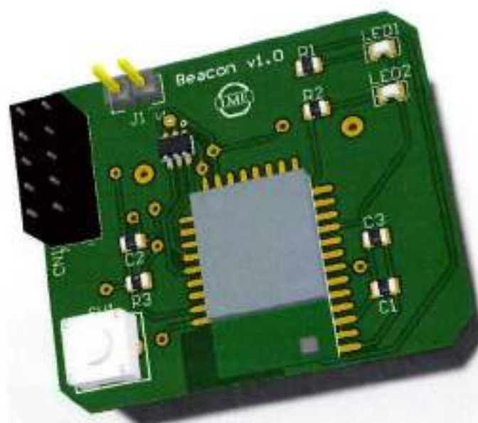
Figura 11 - Vista 3D da Breakout Board v1. Desenvolvido com o software Allium Designer
