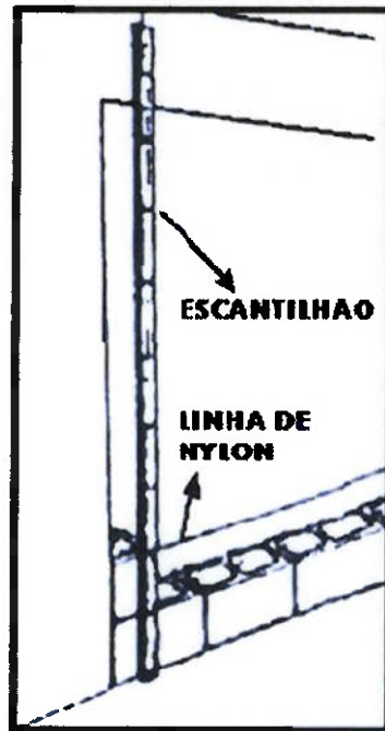
Figura 0.8 - Utilização de escantilhão
