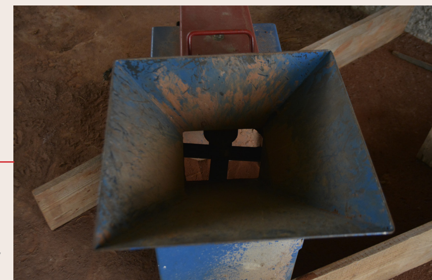
Figuras 44 e 45. Destorradora de terra no Ass. Rosa Luxemburgo. Fonte: Autoria própria, 2021.
