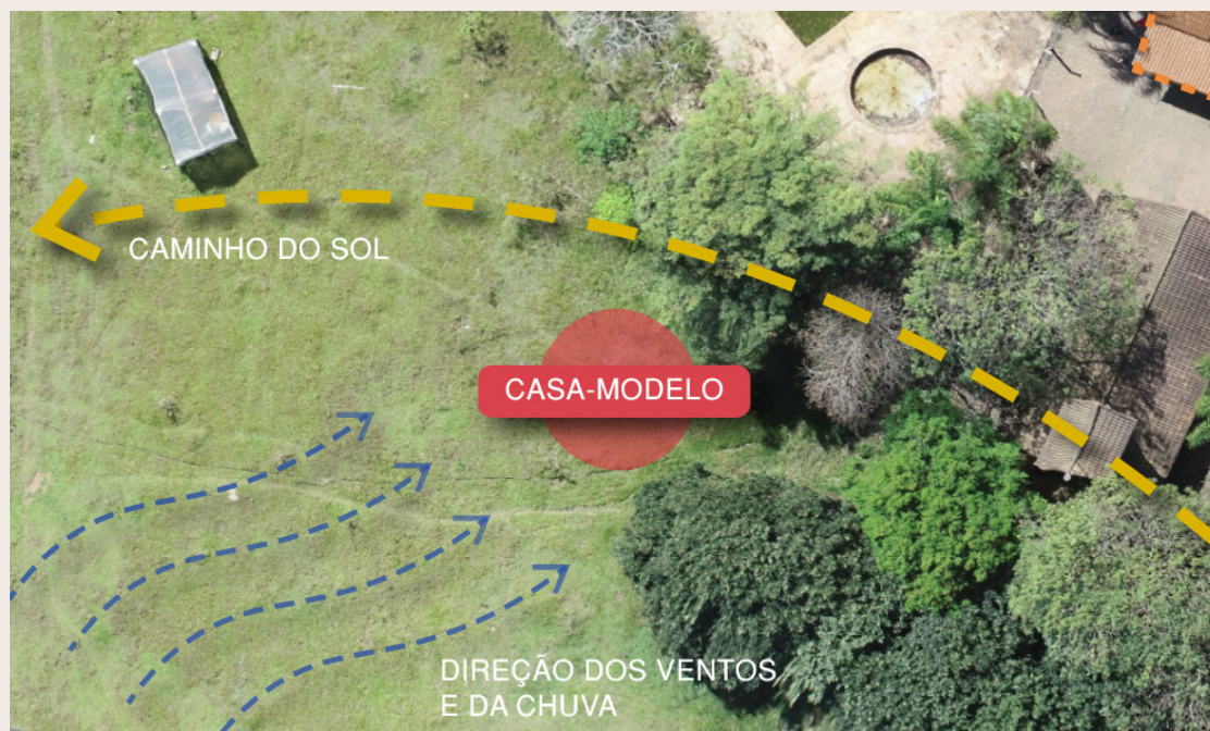
Figura 68. Implantação da casa-modelo, direção dos ventos e da chuva, e caminho do sol. Esquema ilustrativo.
