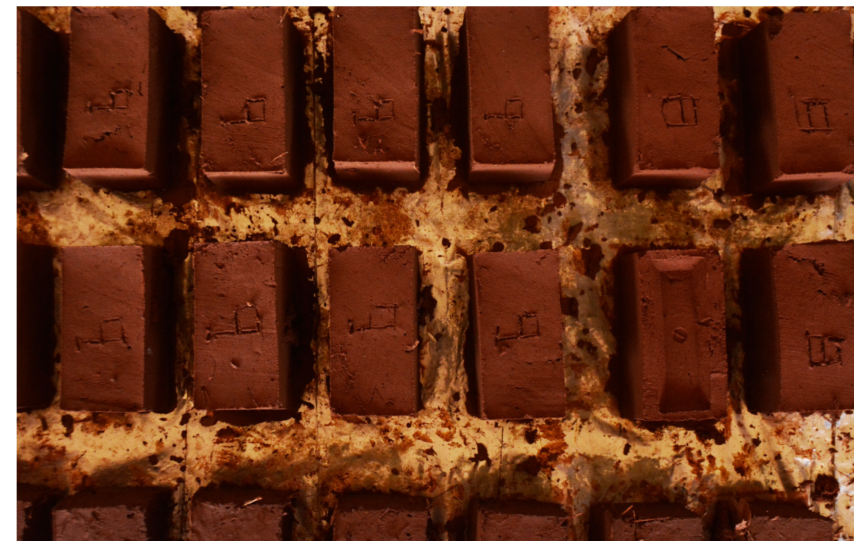
Figura 64. Blocos de adobe fabricados pelos próprios assentados. Os números gravados nos blocos são para marcar as diferentes misturas e traços. Fonte: Autoria própria
