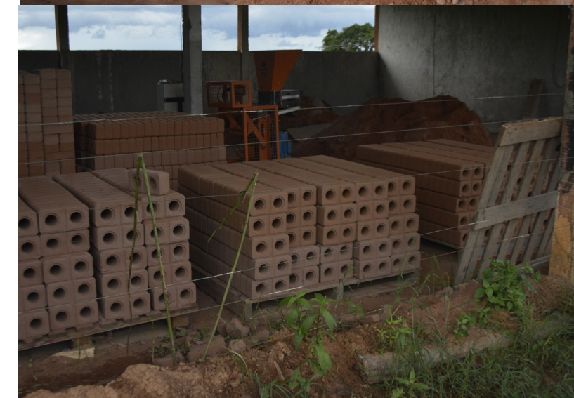
Figura 56. Blocos de BTC já fabricados no momento de nossa visita. Autoria própria, 2021
