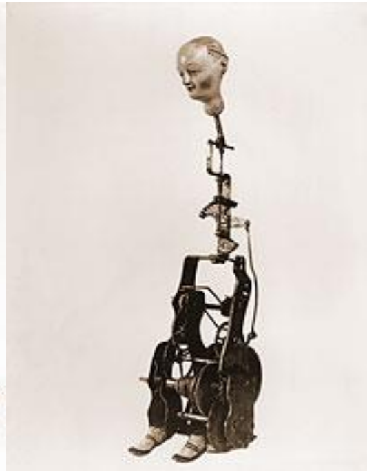
Figura 46 - Mecanismo interno de “A Mulher Dançante Com Alaúde” (XVI)
