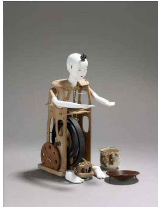
Figura 61 - Mecanismo interno do “Chahakobi Ningyo” de Tamaya Shobei IX (2005)
