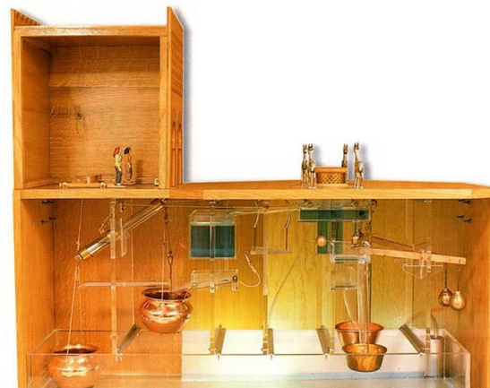
Figura 20 – Vista em corte do “Relógio-Gazela” de al-Muradi, reconstrução por Eduard Farré (1990)
