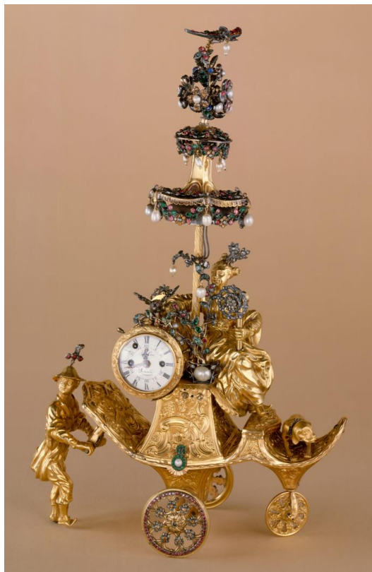
Figura 57 - Autômato na forma de carruagem puxada por um chinês de James Cox (1766): a carruagem anda com uma mola que faz girar as rodas, e pequenas alavancas giram o cata-vento da mulher e as asas do pássaro
