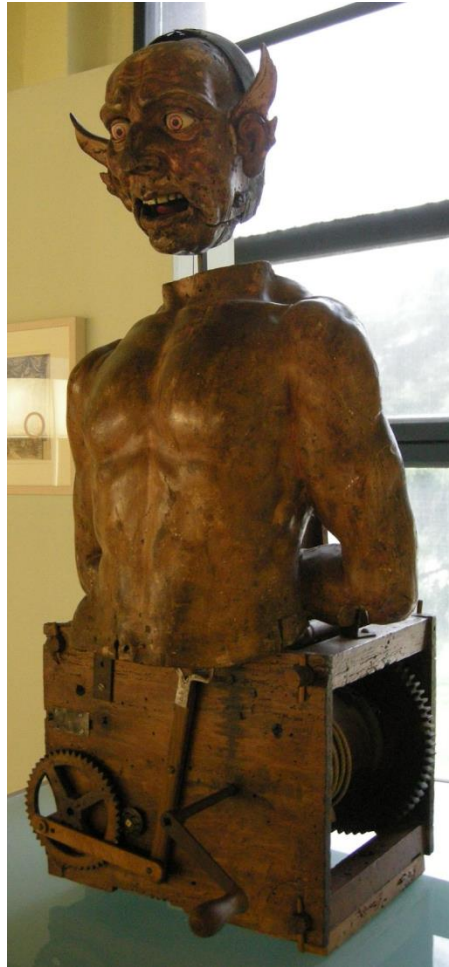
Figura 52 - Autômato de Demônio (séculos XVI-XVII): criado a partir de um torso de madeira do século XVI (provavelmente representando o Cristo), ao qual foi incorporado uma cabeça de demônio e um mecanismo de engrenagens que movimentava a cabeça, os olhos e a língua
