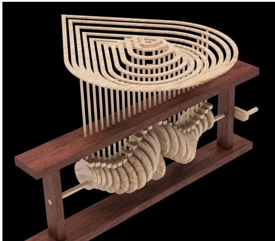
Figura 2 - Árvore de cames utilizada na construção de um autômato, que produz um movimento de onda
