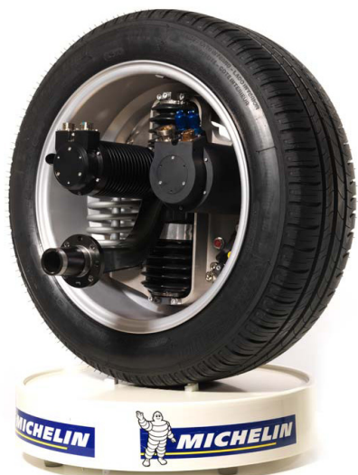
IMAGEM 55: Michelin Active Wheel, exemplo de in-wheel motor. Fonte: http://www.autoblog.com/
