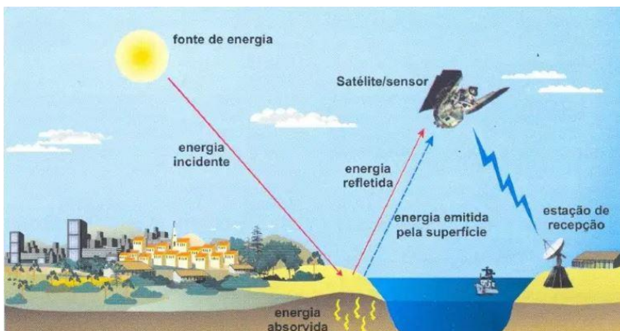
Figura 5 - Esquema representando comportamento dos raios solares e sistemas de captação da REM
