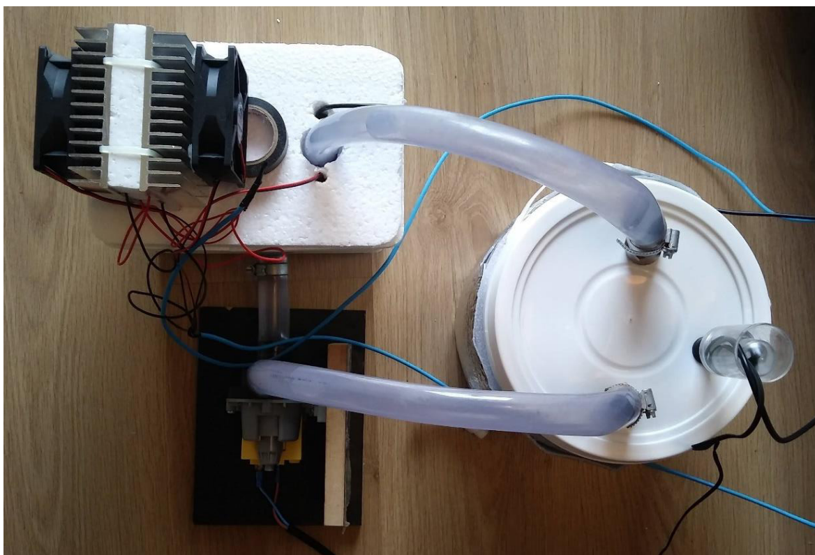
Figura 20 – Vista geral do sistema de controle de temperatura e fermentador
