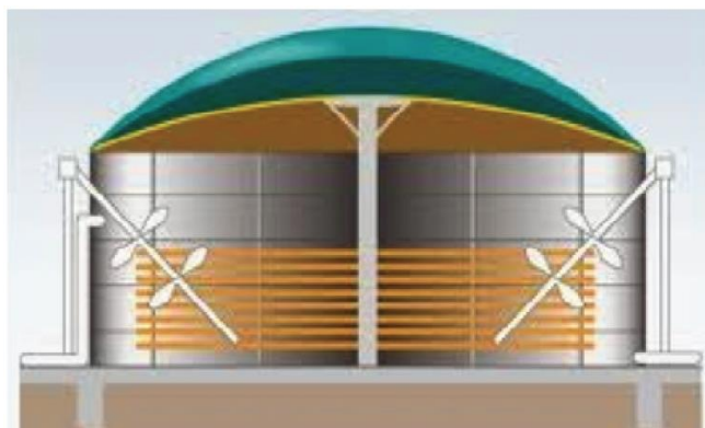
Figura 3.2 - Representação esquemática de um reator CSTR. Fonte: Probiogás, 2015.
