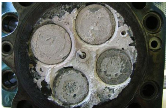
Figura 3.10 - Equipamento danificado por incrustação de siloxanos. Fonte: Evoet, 2018.
