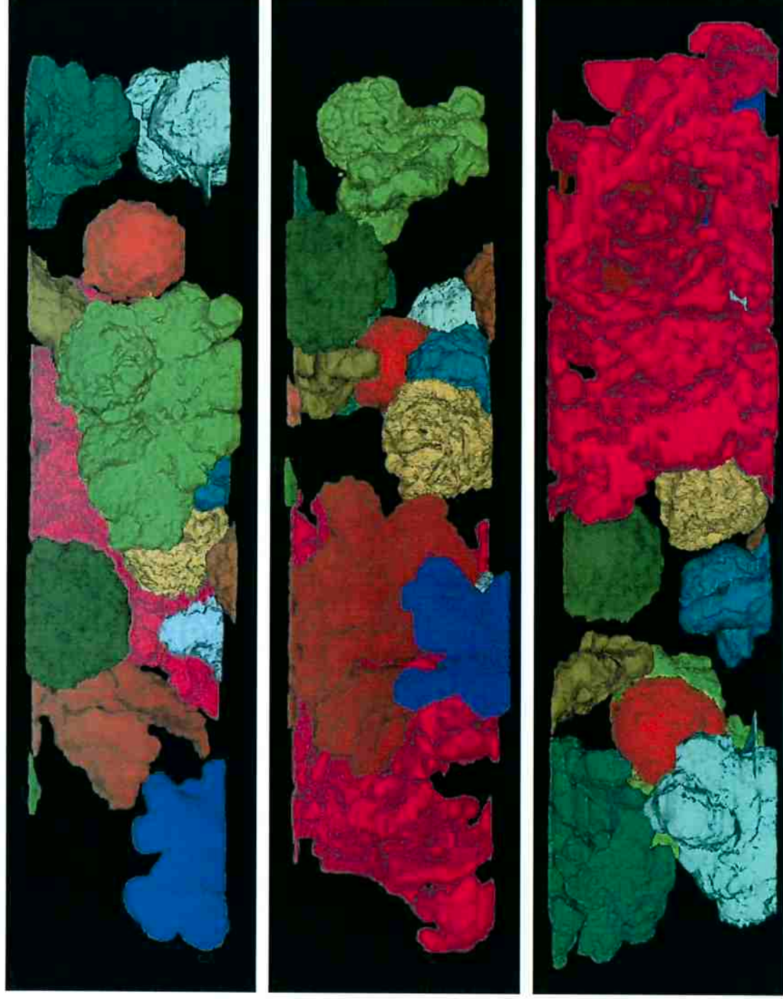
Figura 40 - Reconstrução 5 da grafita compacta a partir de imagens em 200X de aumento, vistas laterais
