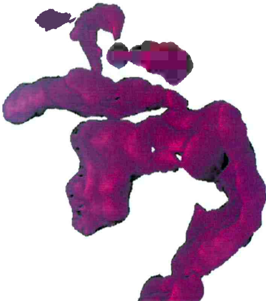
Figura 15 – Resultado preliminar da reconstrução da grafita vermicular a partir de 37 seções espaçadas em aproximadamente 1\mu\text{m} .
