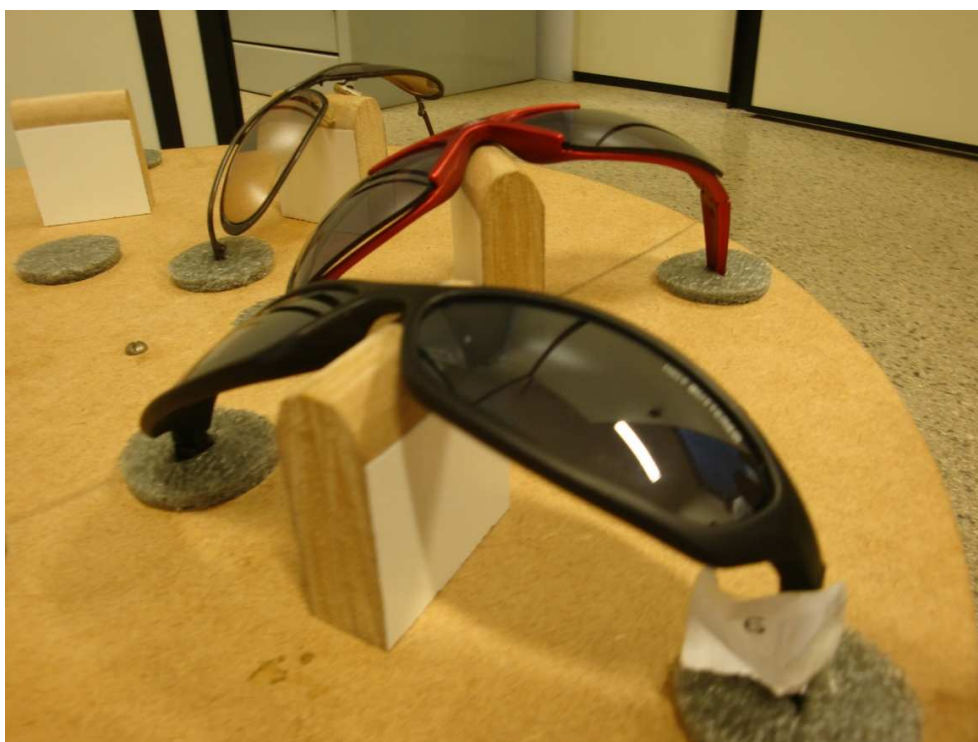
Figura 2.16. Óculos posicionados no disco para o ensaio
