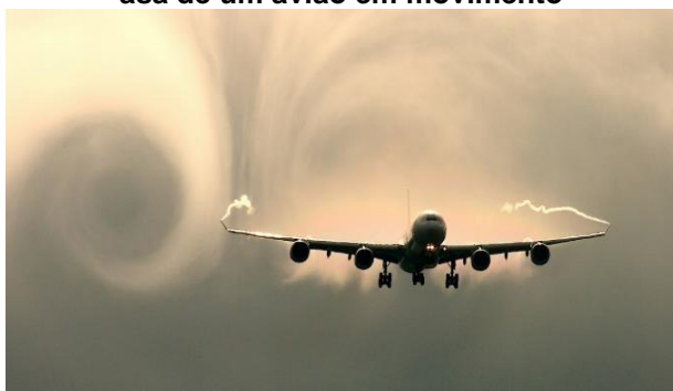
Figura 4 - Exemplo de vórtices formados pela asa de um avião em movimento
