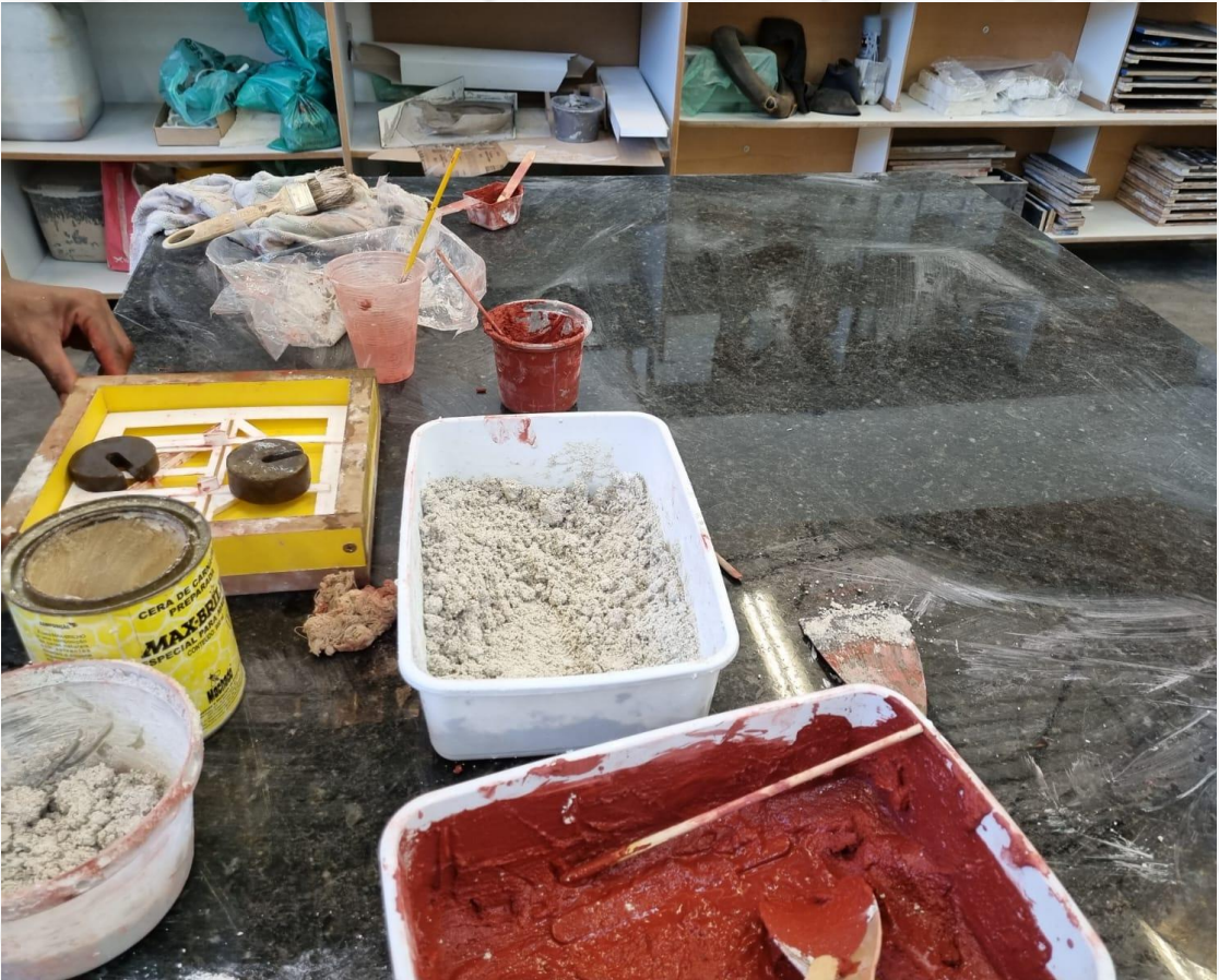
Teste 2 documentado: Processo de inserção de massa na forma: massa a ser inserida com contrapeso. Embora tenha auxiliado a igualar as alturas da forma, dificultava ainda mais o processo de adição da massa.
