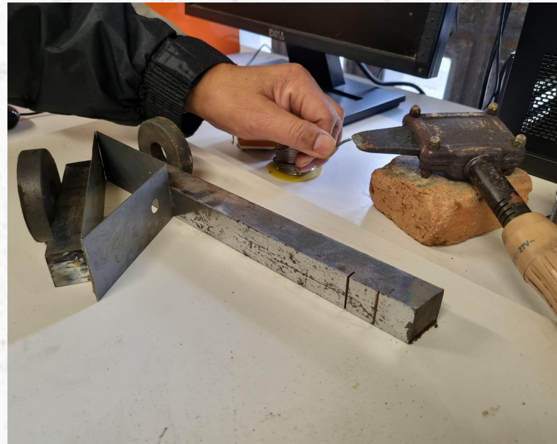
Estanho sendo derretido pelo ferro solda. O processo é demorado dado o tempo necessário para aquecimento do ferro, visto que o ponto de fusão do estanho é superior a 200°C.
