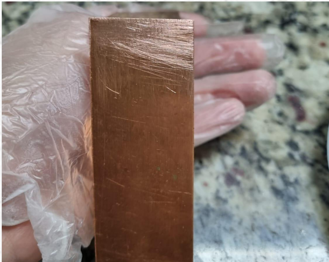
Detalhe da chapa de cobre com a extremidade lixada, para então receber a cola/solda.
