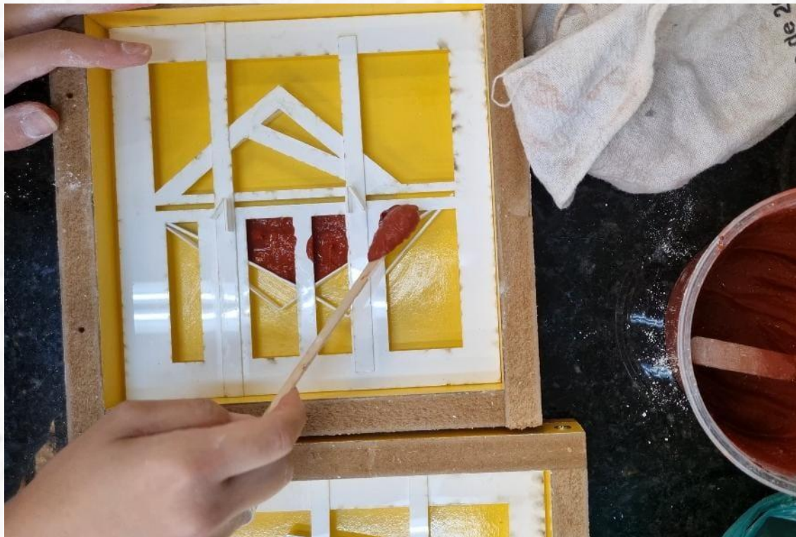
Processo de inserção de massa na forma. O guia criado tornou o processo mais complexo, visto que tinha-se certa dificuldade em visualizar e mesmo aplicar a massa, que era feita com auxílio de uma pequena pá. Teste feito sem contrapeso.
