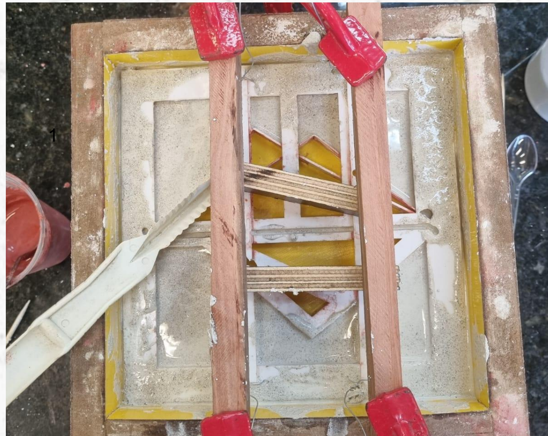
Adição de massa na forma: optou-se por colocar areia não peneirada no fundo "branco", pois cria-se um efeito de textura na peça.
