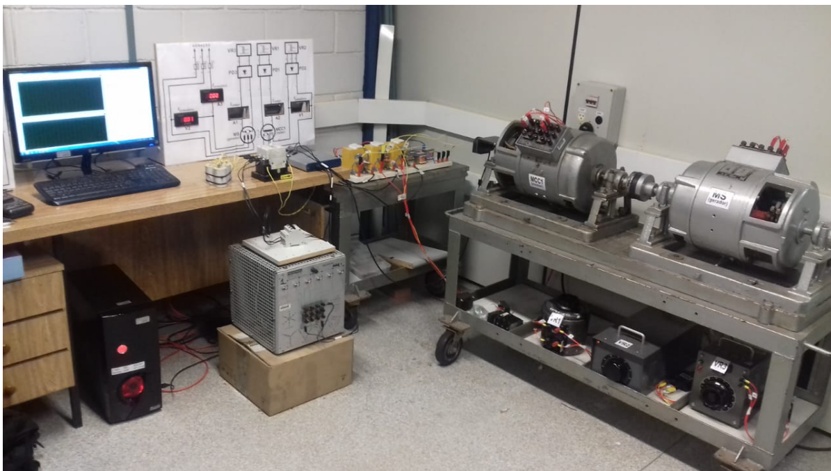
Figura 32: Foto da bancada do Laboratório de TCC em Máquinas Elétricas composta por uma máquina de corrente contínua e um gerador síncrono
