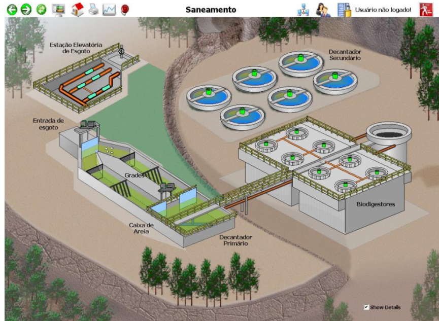
Figura 12: Exemplo de aplicação em SCADA
