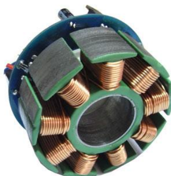
Figura 7: Representação de um motor CC sem escovas
