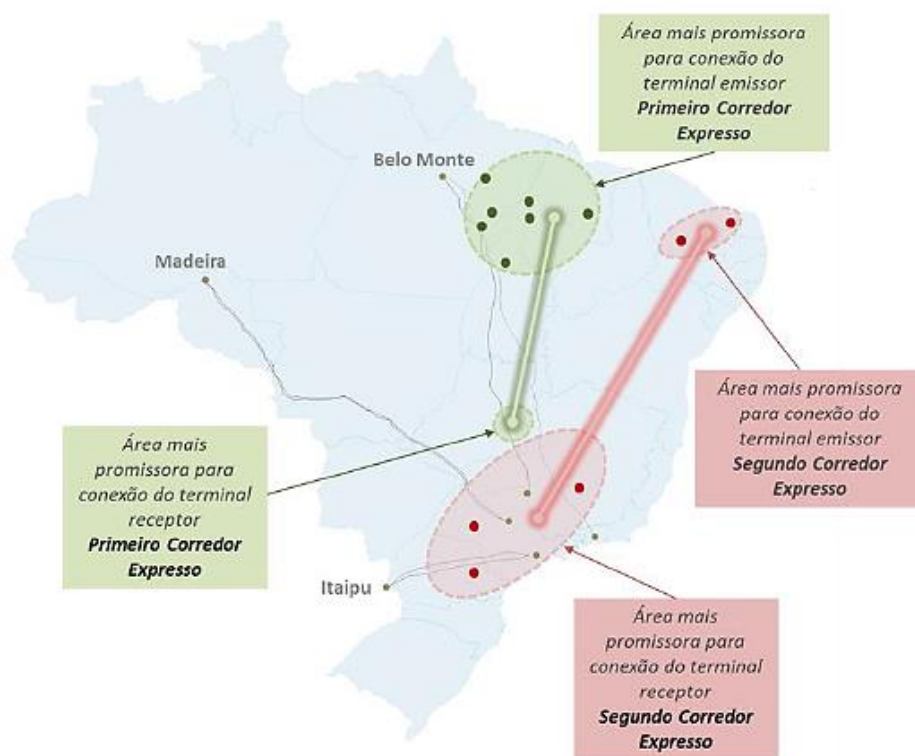
Figura 2.12 – Concepção básica para os novos corredores de transmissão em corrente contínua
