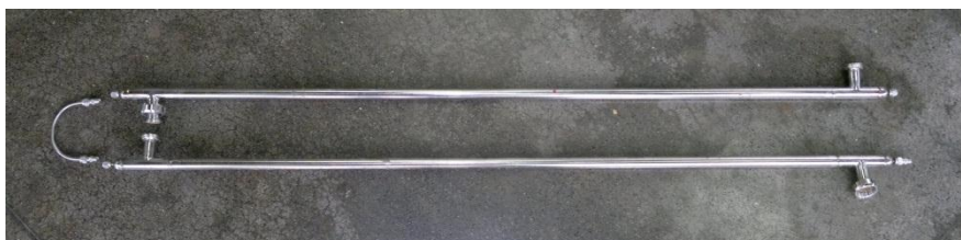
Figura 4 - Grampo (módulo) do trocador bitubular
