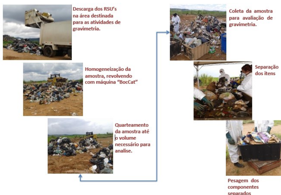
Figura 1 – Esquematização do procedimento para análise da composição gravimétrica dos RSU.
